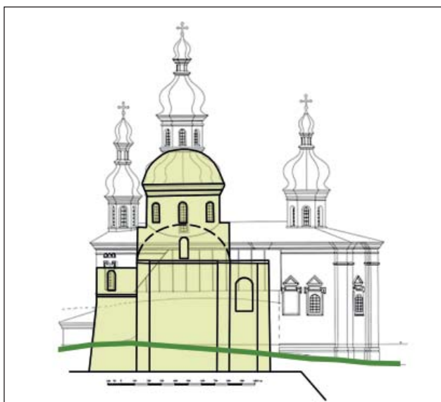
Іл. 6. Іллінська церква. Вид з півночі (обміри М. Говденко). Схема збережених середньовічних конструкцій. Рівень сучасної поверхні відзначений лінією
