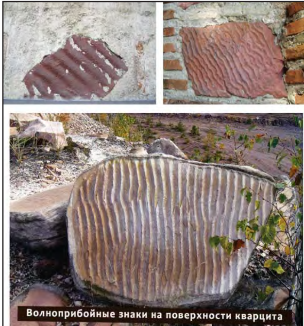
Іл. 17. «Брижі пустелі» на поверхні червоного кварциту: 1 – Софія Київська, 2 – церква Святого Василя в Овручі, 3 – кар’єр на Овруччині. Фото В.К. Козюби та [6, вклейка між с. 112, 113]
