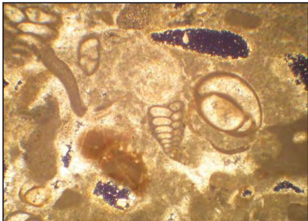
Іл. 9. Петрографічний шліф вапняку, збільшений у 37 разів (із залишками черепашок викопних організмів). За І.С. Нікітенком
