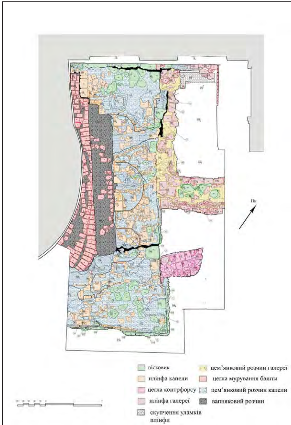
Ил. 15. Пiвденно-схiдна прибудова Спасо-Преображенського собору. План з позначенням рiзночасових мурувань
