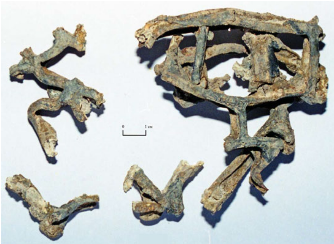
Іл. 13. Уламки свинцевої рамки для кріплення вітражного скла (Київ, Михайлівський Золотоверхий собор). Світлина А. Чекановського
